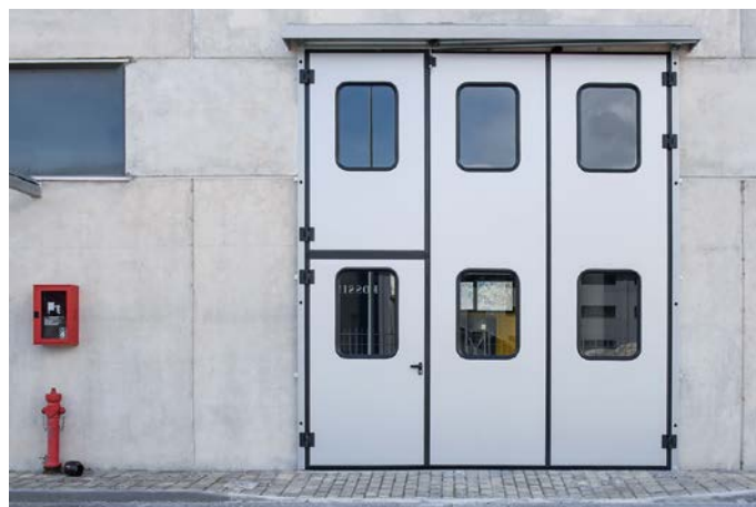
Modello a 3 ante (2+1) SGP con applicazione speciale, apertura delle ante verso l'esterno, binario superiore corredato di scossalina di copertura.
