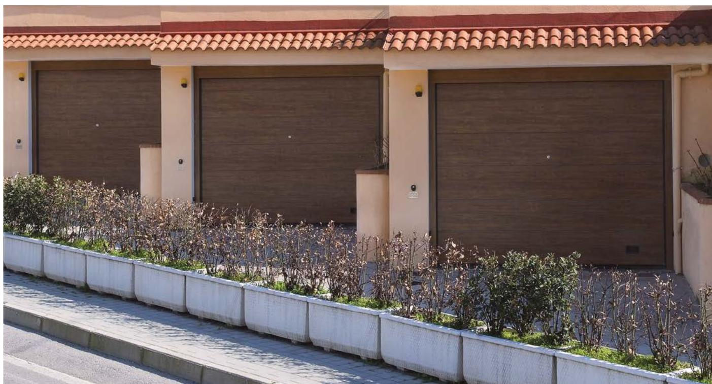
La parte mobile è composta da **pannelli coibentati** di altezza 500 mm, con lamiera preveniciata interna ed esterna spessore 0,5 mm, nelle **varie colorazioni e modelli**. Il coibente è in poliuretano espanso ad alta densità.
