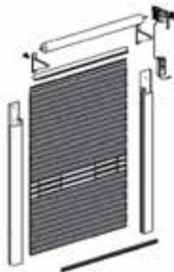
Serranda con assale senza molle e motore laterale.
