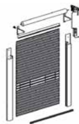
2. Serranda con assale senza molle e motore laterale
